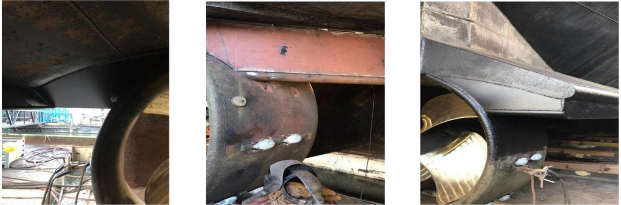
Figure 12 : Optimisation de la partie arrière et des hélices des bateaux (Source : CONTARGO)
