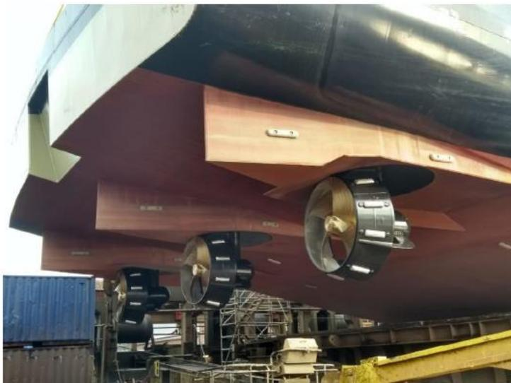
Figure 14 : Conception de l'arrière d'un bateau équipé de 3 propulseurs, le diamètre des hélices étant réduit pour la navigation en eaux peu profondes (source : MARIN, photo : S. Oudakker, Oudcomb)
