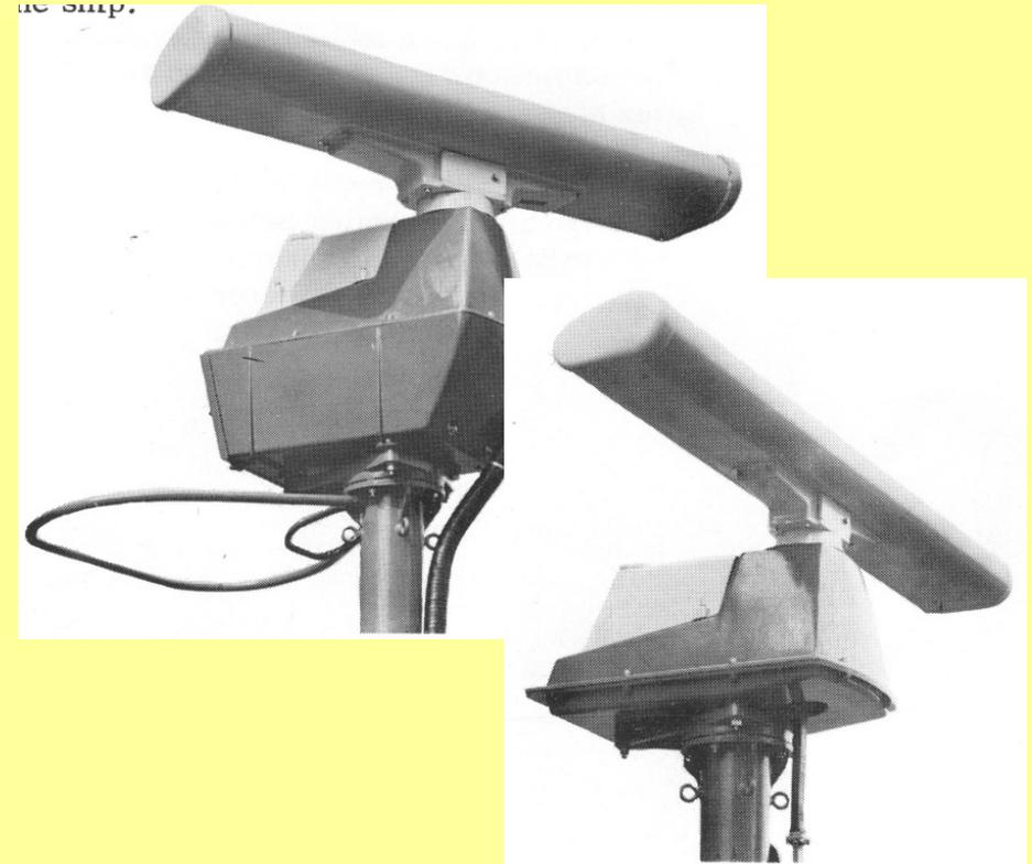
In der Anfangsphase waren nur die Antenne, der Antriebsmotor und der Synchrongenerator im Freien untergebracht. Antenne und Transceiver waren über einen Hohlleiter miteinander verbunden.
