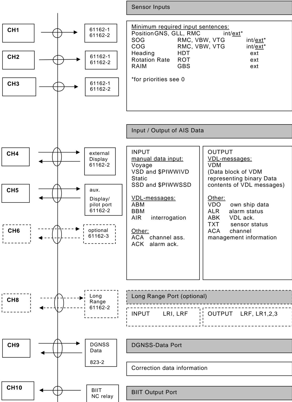
**Annex E (informative) Blockdiagramm eines AIS Prüfsystems**
