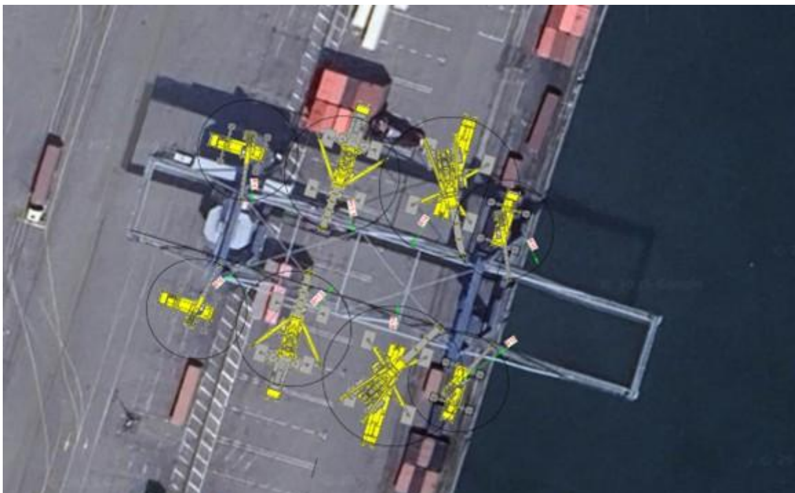
Afbeelding 3: bovenaanzicht van portaalkraan nr. 103 met plaatsing van de kranen voor de demontagewerkzaamheden
