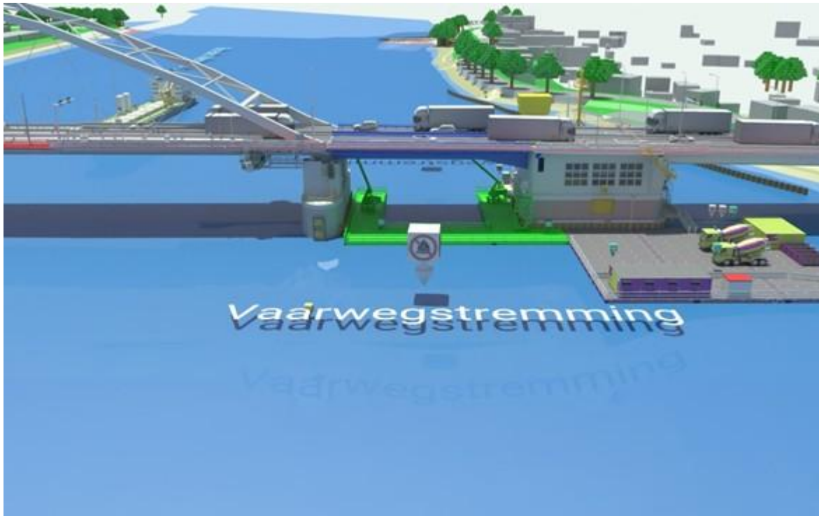
Figuur 1: de situatie tijdens de werkzaamheden aan het beweegbare deel van de Papendrechtse brug. In deze situatie is de doorvaart van het beweegbare deel van de brug gestremd.
