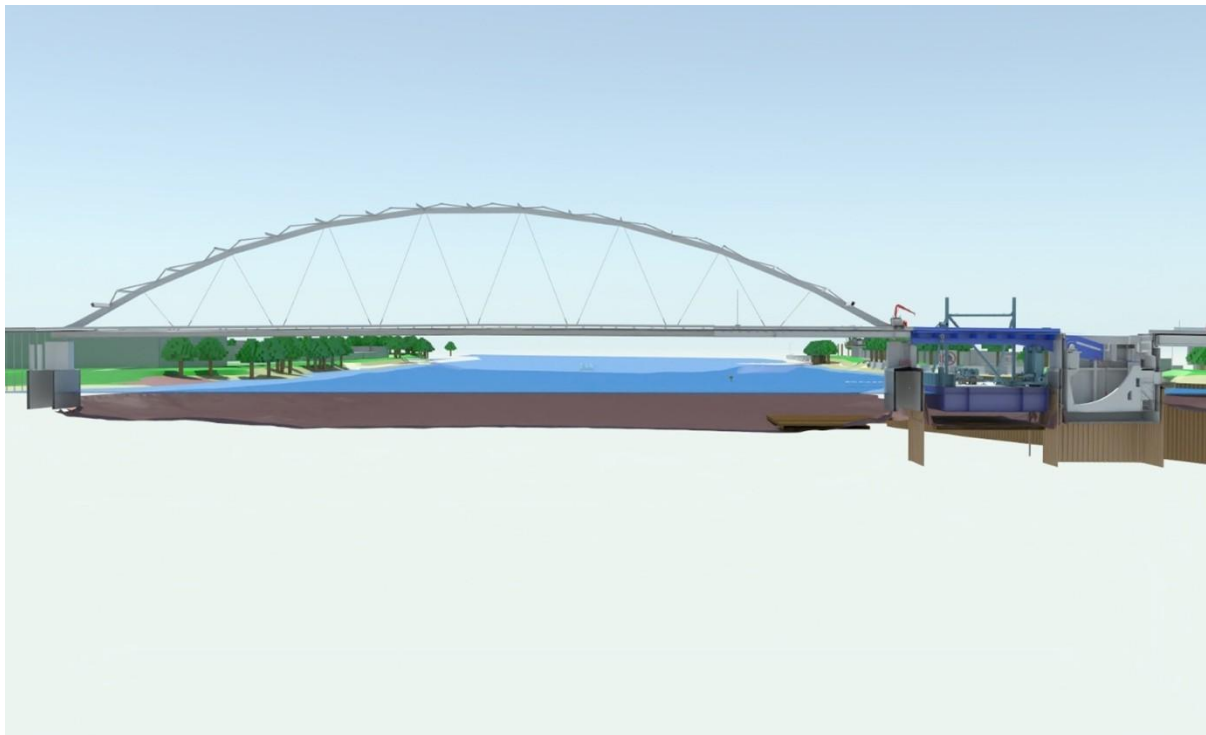
Figure 3 : Plan longitudinal avec profil du fond du lit. Le site des travaux avant l'acheminement aller et retour par flottaison de la volée du pont mobile est inclus dans l'illustration.
