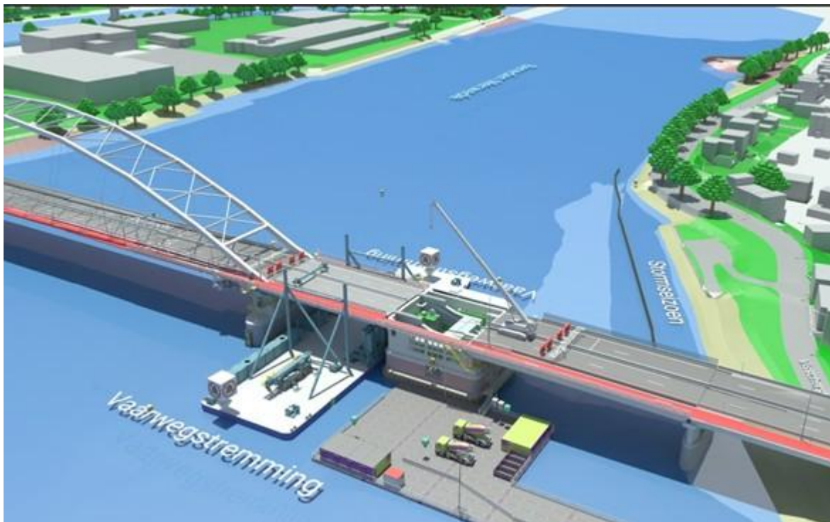
Figure 2 : Situation avant l'acheminement aller et retour de la volée par flottaison avec fermeture complète de la voie d'eau.
