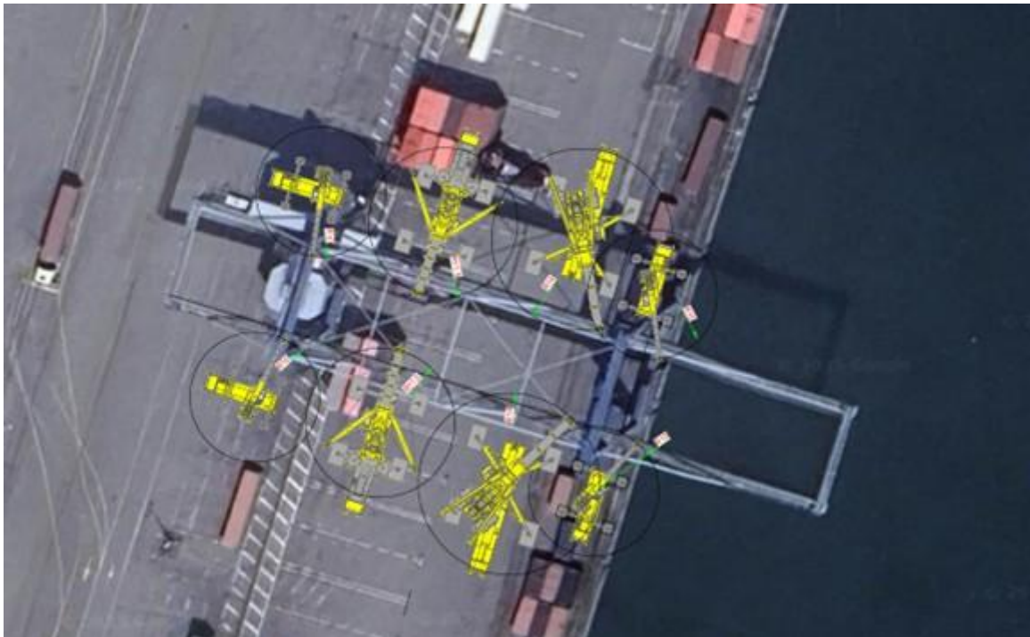
Abbildung 3: Luftbild des Portalkrans Nr. 103 mit Aufstellung der Kräne für den Abbau
