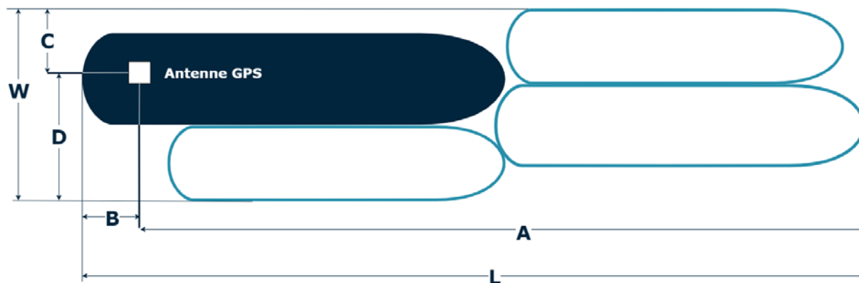
Indications concernant les valeurs W, L, A, B, C et D d'un convoi
