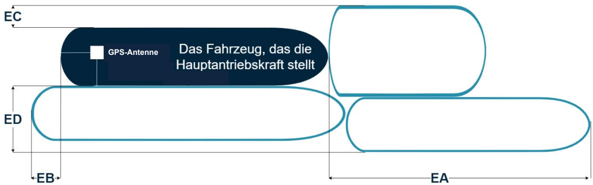
Erläuterungen zu den EA, EB, EC und ED Werten für einen Verband
